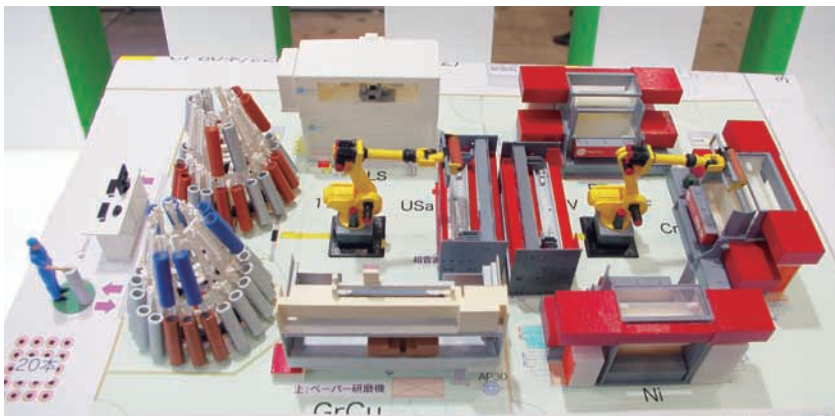
CAD データから 3D プリンターで作成した New FX2 の立体モデル 客先にはこれを持参し、イメージをふくらましてもらう
