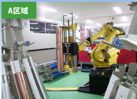
在A区域可自动进行研磨, 超声波清洗, 挂胶及激光制版工程
