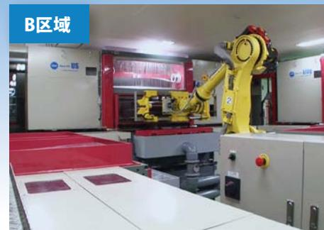
显像, 腐蚀, 感光胶剥离, 超声波清洗, 镀铜, 镀铬都由机器人自动搬送完成
