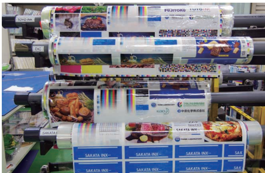
シンク・ラボラトリーは、New FX版で花王、サカタインクス、DICグラフィックス、東洋インキのグラビアインキの印刷適性をテストしている
