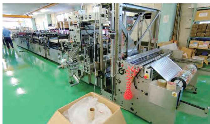
新設したトタニ技研工業の最新三方シール自動製袋機 「BH-60DLLSC」
