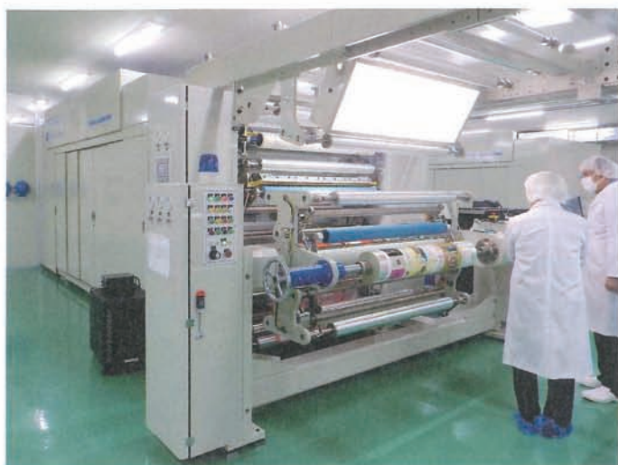
軟包装用インクジェット印刷機の巻取部から
