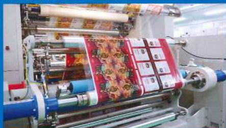
巻出し、巻取りの自動切替え対応
