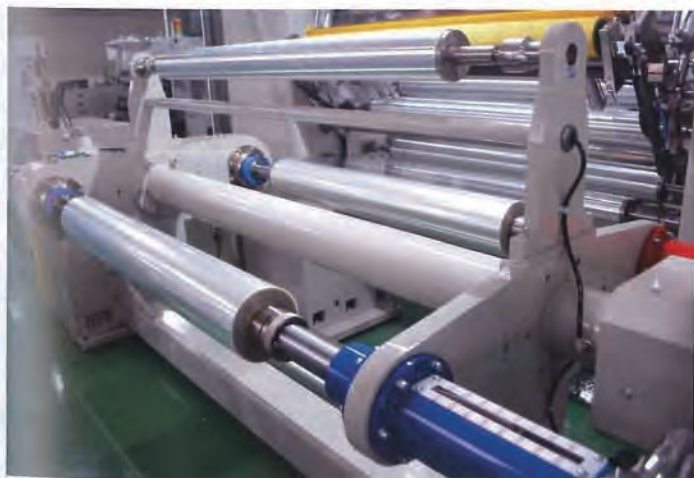
BMF の Type 1000 FullAuto ターレット機構 (左: 巻出、右: 巻取)
