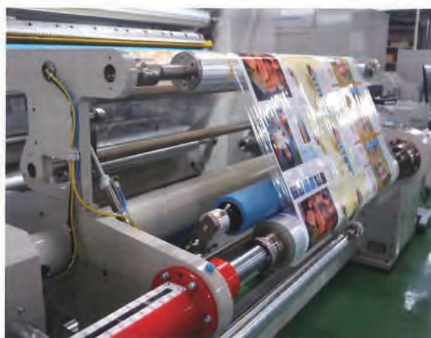
BMF の Type 1000 FullAuto ターレット機構 (左: 巻出、右: 巻取)
