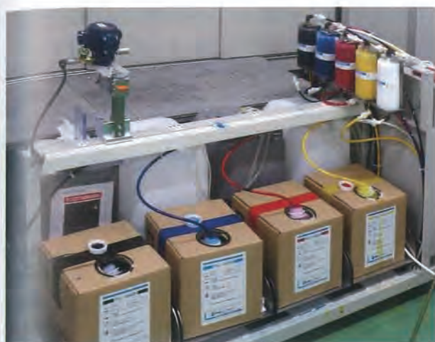
BMF の Type 1000 FullAuto 用のインクタンク
