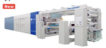
新製品となる 1000mm 幅対応の表刷り裏刷り兼用機 FXIJ type 1000 Full Auto SP は、表刷り用の白ヘッドを 追加し、最新の表刷り兼用インクを採用することで、デジ タル印刷の魅力を最も活かせる日配品対応します。さらに 従来機から品質からの向上に加えて、ロングランの安定性 や、乾燥能力強化による高速化、基材毎の乾燥条件による 速度低下を抑制しています。
