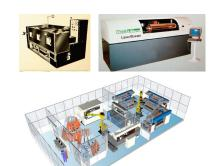
また8年前より、ロール to ロールでの水性インクジェットプリンター FXIJ の 開発を進めており、専用インクは当初より花王様の協力でスタートしましたが、現在は自社開発による CMYK プロセスカラーと、高濃度白インクを確立しており、1,200dpi ヘッドと複合したシステム特許も取得しております。これにより、他社インクジェット印刷機と比較して、高い白濃度を維持しながら、インク使用量は1/2となり、大幅なコスト削減が可能となります。対応基材幅1,100mmで PET、OPP、ナイロン、シュリンク、和紙や不織布まで各種基材に対応し、食品トレー、壁紙などの建材、文具などの熱転写製品にも応用可能です。
